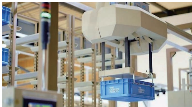
非接触給電方式で、キャリア（搬送容器）がレールを走っていく
