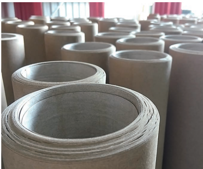
竹より取扱いが容易な“平巻き紙管”による手筒花火
